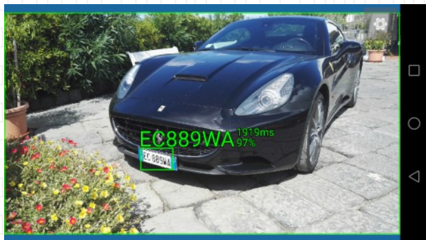
Esempio utilizzo su smartphone: inquadrata la scena, Recogniform ANPR riconosce la targa mostrandone il valore e la confidenza di lettura.
